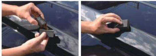
付属のスポンジに2~3滴程度コーティング剤を染み込ませます。塗り込みますと、スポンジがスーッと伸びるのが分かるかと思えます。スポンジの滑りが悪くなってきましたら、再度スポンジに液剤を塗布してください。
