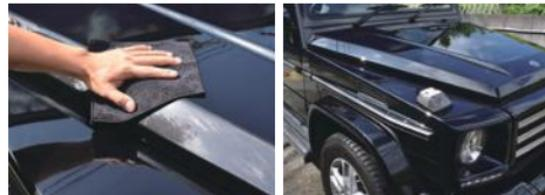
全体的に塗り込みが終わりましたら、時間を置かず、付属のクロスで直ちに拭き上げを行ってください。塗り込みから拭き上げを直ちに行っても、浸透結合によりガラスコーティングは必ず残りますのでご安心ください。
